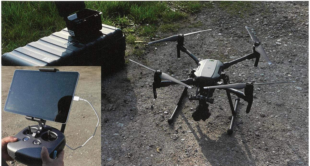
Mit unbemannten Luftfahrzeugen lassen sich Thermalbilder erstellen, die zum Erkennen von Leckagen an Fernwärmernetzen dienen
