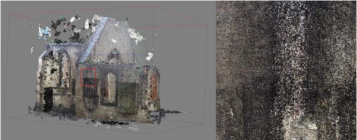
Abbildung 3.5: links: Punktwolke nach Erzeugung der dichten Punktwolke
