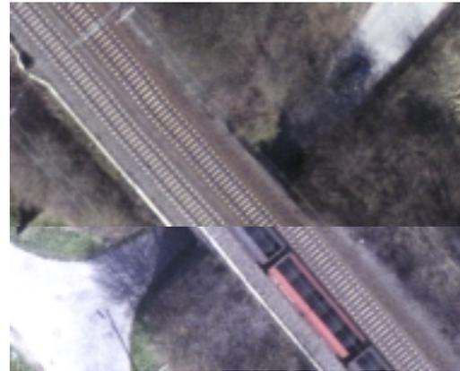
**Abbildung 7.4: Unterschiedliche Lagefehler in verschiedenen Orthophotos**
