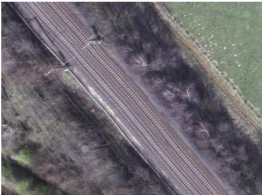
**Abbildung 7.5: „Krumme“ Gleise durch unterbrochene Struktur im Höhenmodell**
