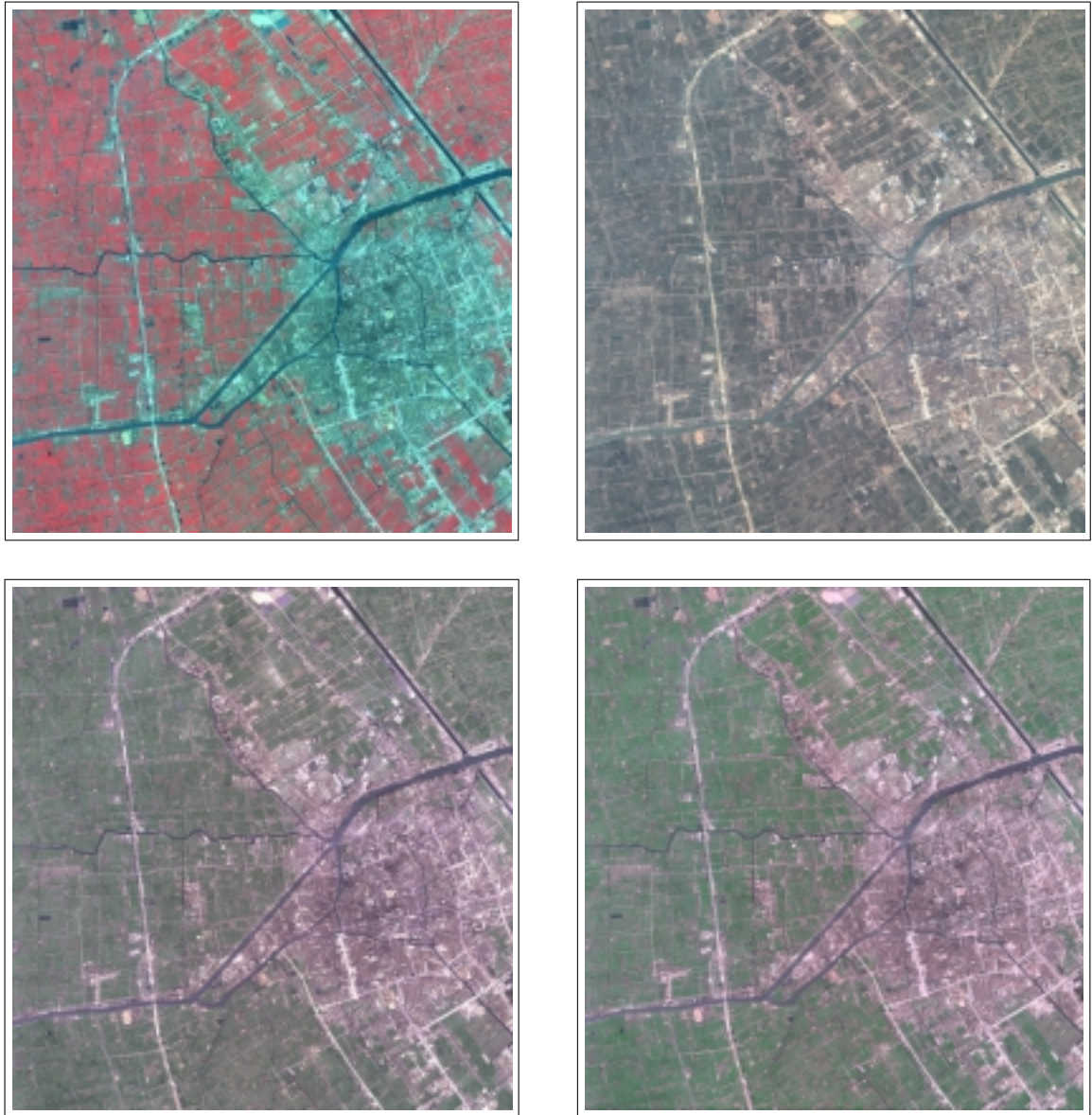
Abbildung 5.6: Aus der CIR-Simulation der Ikonos-Aufnahme (oben links) ergeben sich die Echtfarbandarstellungen durch die Synthese mittels Histogrammangleichung (unten links) und durch die Synthese mit gewichtetem Mittel (unten rechts). Als Vergleich dient die Echtfarbandarstellung durch Kombination der ersten drei Kanäle des Multispektralbildes (oben rechts).
