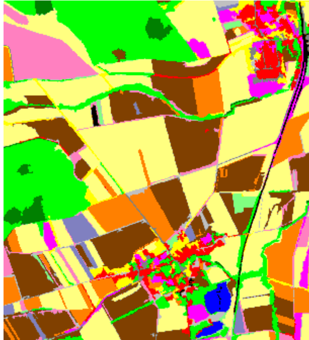
Abb. 103: Nearest Neighbour Klassifikation im Bild mit 4 Meter Auflösung auf 50% verkleinert.
