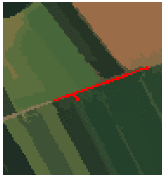
Abb. 66: Segmentierung eines Weges im 4 Meter Bild um 300% vergrößert.
