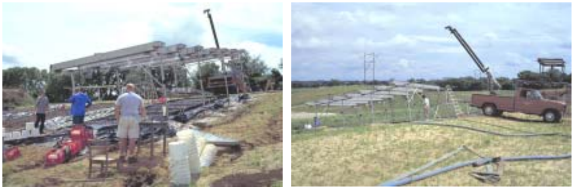
Abbildung 9.1: Photogrammetrische Aufnahme von Beregnungsversuchen im Feld
