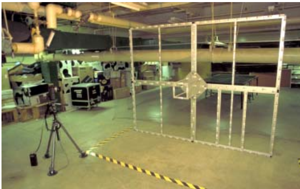
Abbildung 5.7: Testfeldaufnahme mit DCS 1m und 19 mm-Objektiv
