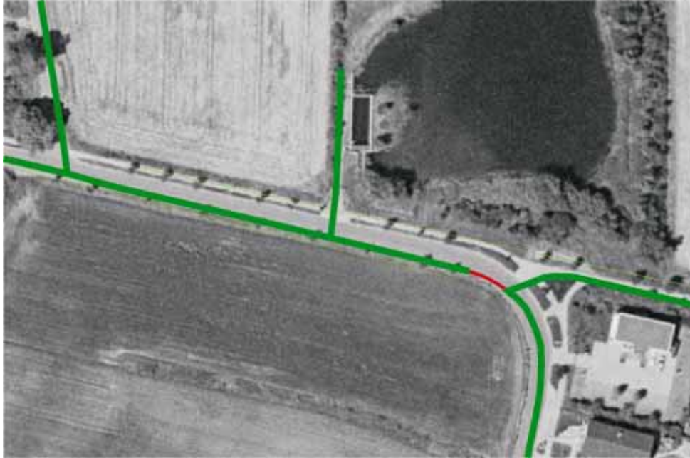
Abbildung 27 : Basis-DLM-Objekte sind nicht korrekt verknüpft (grün = Objekte des ATKIS Basis-DLM, rot = nachdigitalisiertes Objekt)
