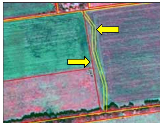
Abb. 6.2: Wertung des Segmentierungsergebnisses (gelbe Linie) als fehlende Grenze (linker Pfeil) und Fehler im Randbereich (rechter Pfeil) im Bezug zu den Referenzdaten (rote Linie)
