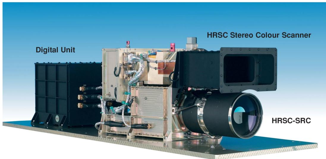
**Abbildung 2.3 Die High Resolution Stereo Camera**
