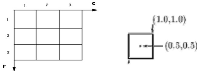
Fig. 18 a: pixel coordinate system.
