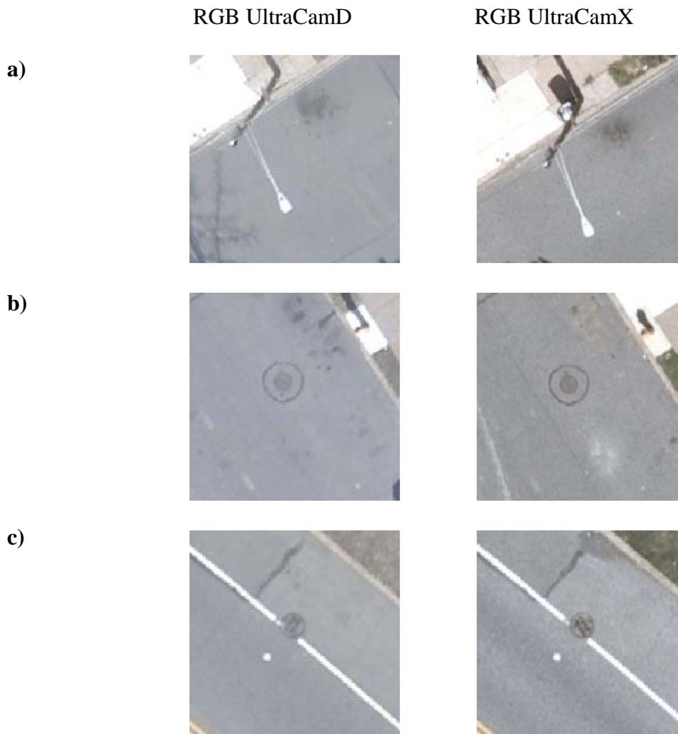
**Abbildung 5.22:** Vergleich der RGB UltraCamD- und der RGB UltraCamX-Bilder; **a:** Laterne bzw. Strommast; **b:** Kontrollschacht; **c:** Abfluss auf der Straße
