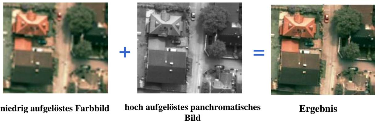
**Abbildung 2.7:** Schematische Darstellung des „Pansharpening“ Verfahrens [Jacobsen, Vorlesungsskript]
