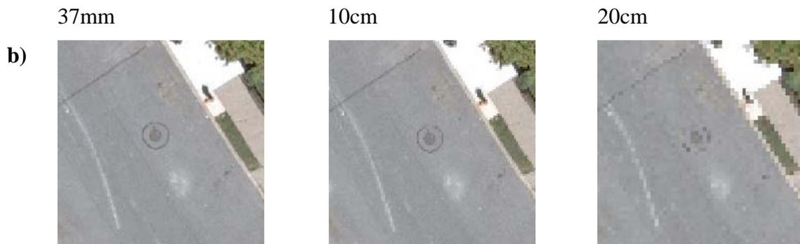
**Abbildung 5.34:** a: Kontrollschacht in panchromatischen DMC-Bildern; b: Kontrollschacht in RGB UltraCamX-Bildern
