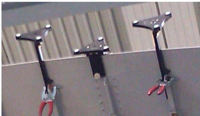
**Abbildung 3.2:** *Stringer* und *Buttstrap*-Adapter (Mitte) befestigt an der Außenhaut der Sektion 18
