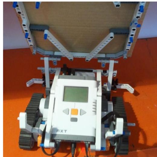
**Abbildung 3.2: Klappbare Signalisierungstafel**
