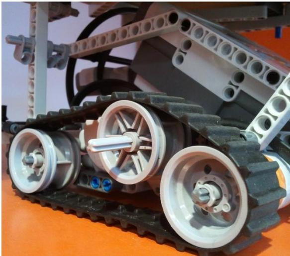
**Abbildung 3.1: Kettenspanner**
