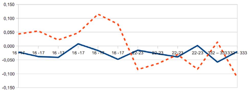
**Abb. 6:** Soll-Ist-Vergleich Streckenmessung im Normalfall als orange, gestrichelte Linie und für den Konvergentfall als blaue, durchgezogene Linie. Auf der Abszisse sind Streckenbezeichnungen (Punktnummeranfang-Punktnummerende) aufgetragen, an der Ordinate die entsprechenden Längenabweichungen in mm.
