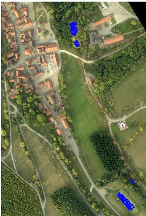
Abb. 5: Klassifikationsergebnis bei Verwendung der Merkmale Höhen- und Intensitätsvariation (K = 93,6 %, V = 61,4 %). Alle drei Gewässer (blau) können detektiert werden.
