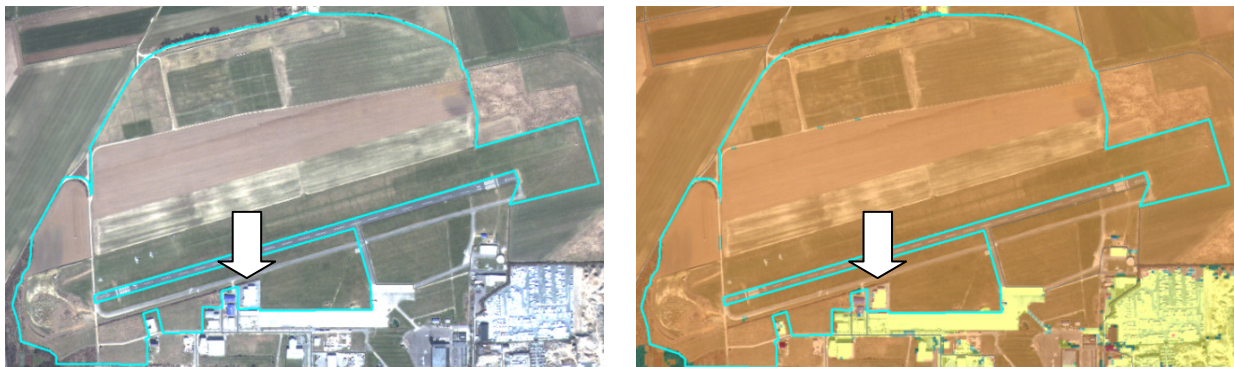
Abbildung 42: Fehlerhaftes GIS-Grünlandobjekt, das tlw. von Siedlung bedeckt ist (Testszene: HI). Links: RGB-Bild, rechts: Ergebnis d. pixelbasierten Klassifizierung (braun: Acker-/Grünland, gelb: Industrie, rot: Siedlung, grün: Wald).
