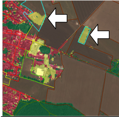
Abbildung 23: In Cyan hervorgehoben sind kleine nicht bewachsene GIS-Ackerlandobjekte, die als Industrie (gelb) falsch klassifiziert wurden. Datengrundlage ist ein multispektrales IKONOS-Bild und ATKIS. Klassifikationsergebnisse: Siedlung: rot, Wald: grün, Ackerland/Grünland: braun, Industrie: gelb).
