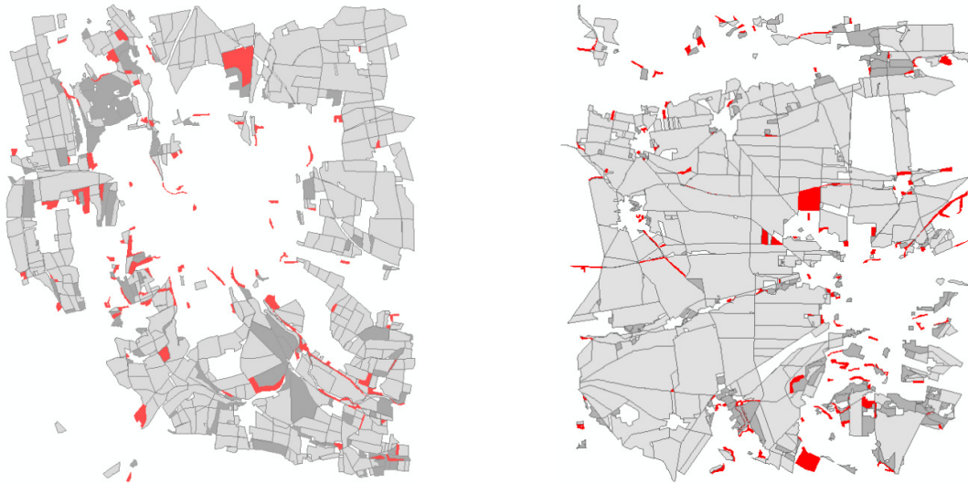
Abbildung 58: Übersicht über die Klassifikationsergebnisse der Szene HI (links) und Szene HBS (rechts) unter Verwendung der Segmentierung (hellgrau: Ackerland, dunkelgrau: Grünland, rot: Zurückweisungsklasse).
