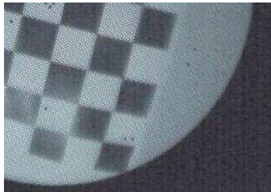
Abbildung 2.3: Wabenstruktur eines durch Glasfasern übertragenen Bildes
