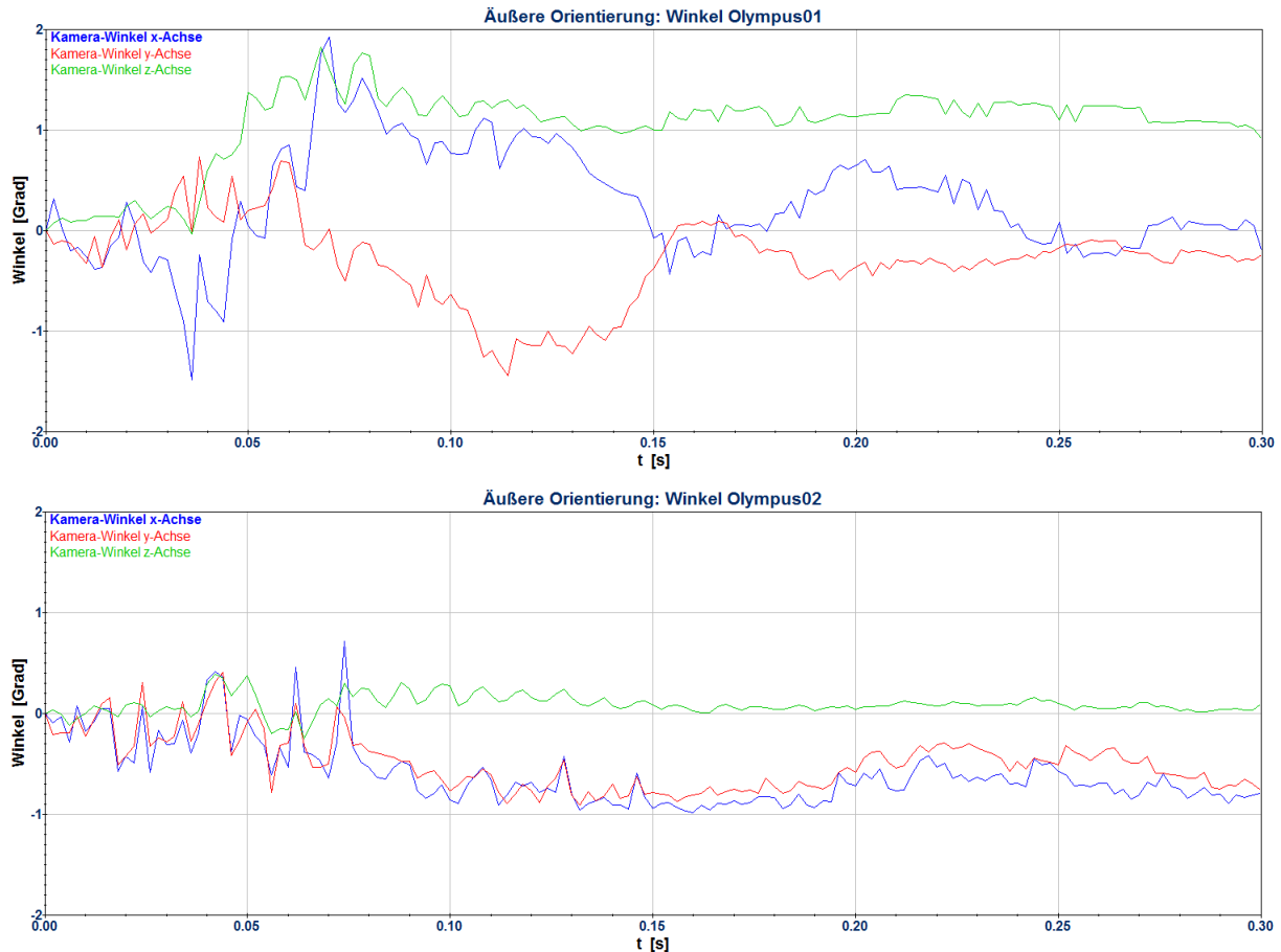
Abbildung 5.7: Rotationswinkel der äußeren Orientierung der beiden Endoskope Olympus01 (oben) und Olympus02 (unten) um die drei Raumachsen
