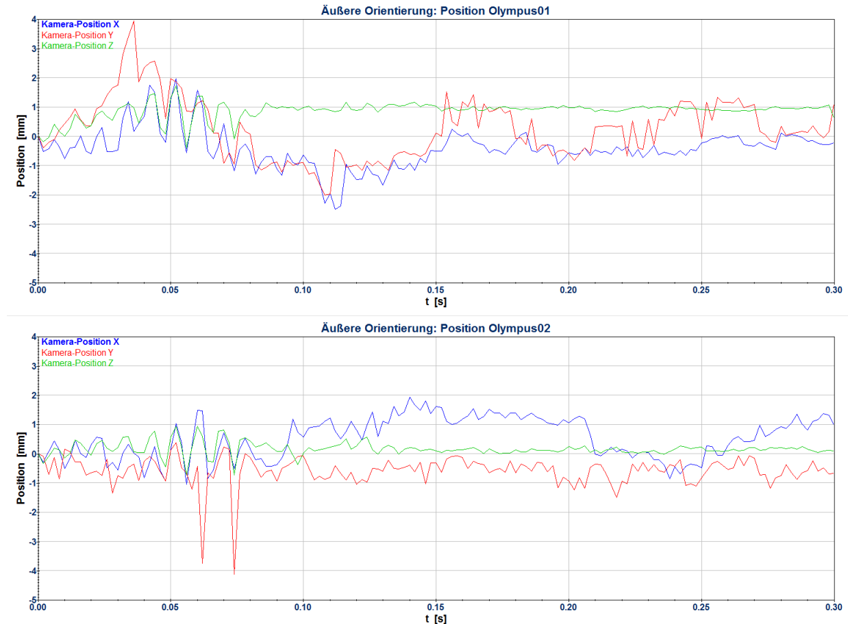
Abbildung 5.5: Positionsveränderung der beiden Endoskope Olympus01 (oben) und Olympus02 (unten) in allen drei Raumrichtungen
