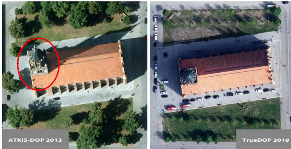
Abb. 9.24: Orthophoto (links), u. a. ist der Turm seitlich sichtbar und analoge Situation als True Orthophoto (rechts) (LAIV 2019)
