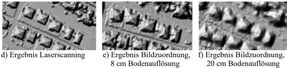
Abb. 9.13: Visueller Vergleich der DOM-Ergebnisse zwischen Laserscanning und digitaler Bildzuordnung (HAALA & WOLFF 2009)
