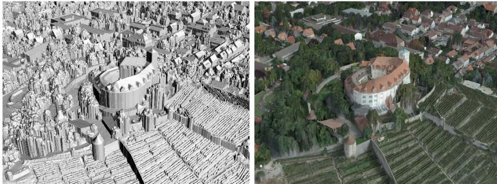
Abb. 9.11: Ergebnisse der globalen Bildzuordnung mittels SGM: links: abgeleitetes DOM, rechts texturiertes Oberflächenmodell (HIRSCHMÜLLER & BUCHER 2010)
