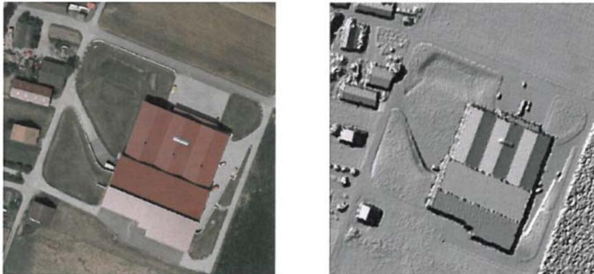
Abb. 9.12: Ergebnisse der DOM Ableitung mittels Laserscanning: links Luftbild, rechts Laserscanningergebnis (HAALA 2009)
