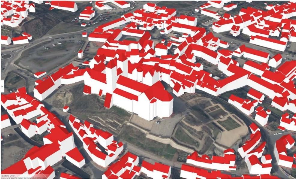
Abb 9.27: LoD2, Darstellung mit DGM und DOP (LVERMGEO LSA 2019)
