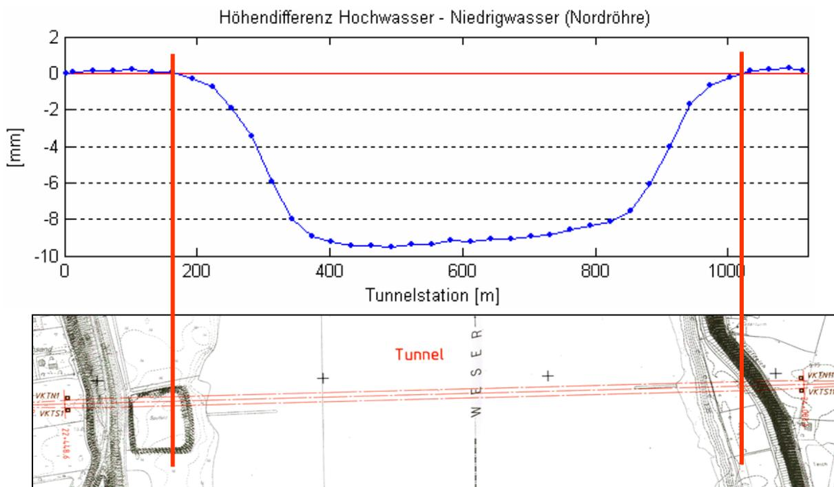
Abb. 5.1: Vertikale Verformung einer Tunnelröhre infolge von Gezeiteneinfluss
