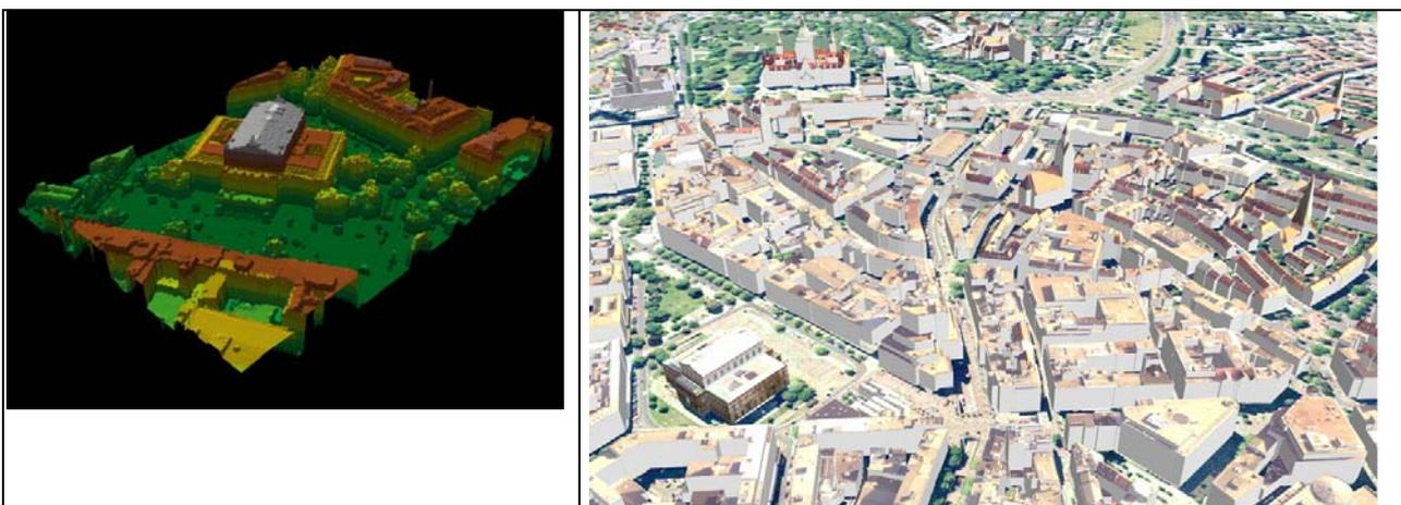
Abb. 6.2: Laserdatensatz: Höhen farblich codiert (links); automatisch rekonstruierte Gebäudemodelle in Form eines 3D-Stadtmodells von Hannover (rechts).
