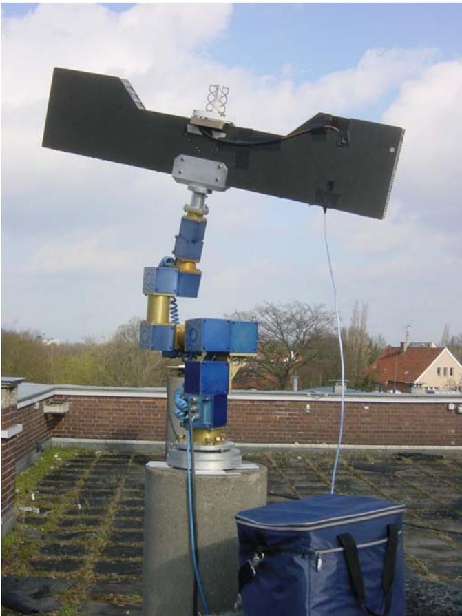
Abb. 4.3: Kalibrierung der GOCE Antenne
