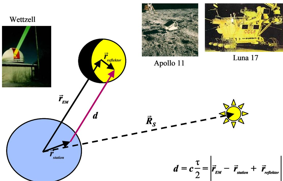
Abb. 2.1: Lunar Laser Ranging: Grundprinzip, Beobachtungsstation Wetzell sowie Reflektoren auf dem Mond [Quelle für Reflektorabbildungen: NASA]
