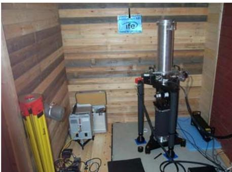
Abb. 2.2: Das Absolutgravimeter FG5-220 des Instituts für Erdmessung
