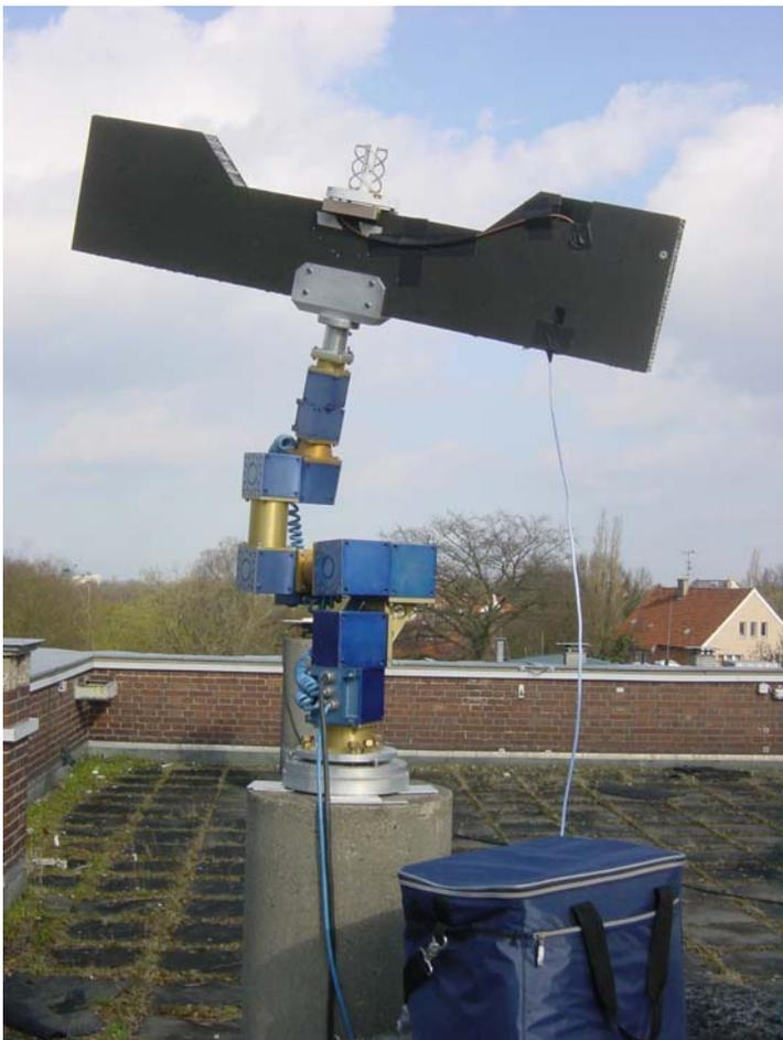
Abb. 4.3: Kalibrierung der GOCE Antenne
