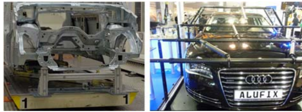
Abb.: 2 Links Bauteilaufnahme mit geklebten Referenzmarken. Rechts Trägerkonstruktion mit geklebten Referenzmarken
