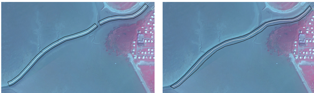
Abbildung 5.23: Befliegung „Außenweser 2004“ – Näherungslösung sowie Umringspolygon für die nördliche (links) und südliche Böschung (rechts). Die Mittelachsen sind in weiß und die Umringe in schwarz dargestellt.
