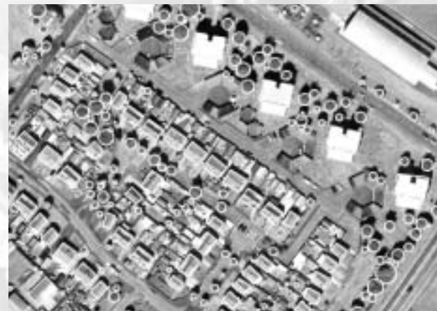
Testgebiet zur automatischen Objektextraktion. Das System hat Bäume und Häuser automatisch erkannt und rekonstruiert.
