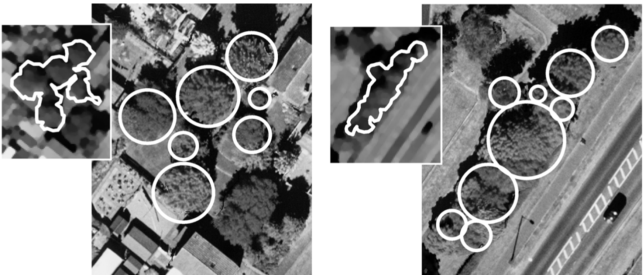
Abb. 12: Zwei Ergebnisse einer automatischen Extraktion von Bäumen aus Multispektralbildern und einem DOM in mehreren Auflösungsstufen (aus STRAUB, HEIPKE 2001)
