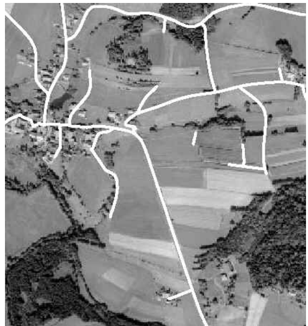
Abb. 10: Ergebnis einer automatischen Straßenextraktion im offenen Gelände (© Lehrstuhl für Photogrammetrie und Fernerkundung, Technische Universität München)
