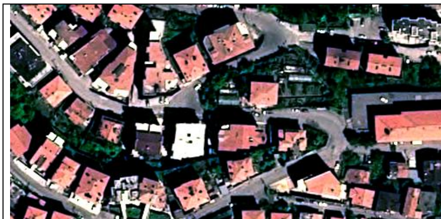
Abb. 2: pan-Schärfung eines Pleiades Ausschnitts durch modifizierte Brovey-Transformation
