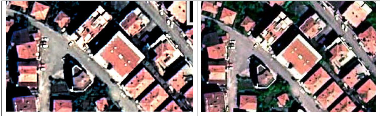
Abb. 3: links: pan-Schärfung mit nächster Nachbarschaft Zuordnung, rechts mit bilinearer Interpolation
