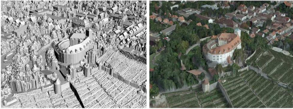
Abb. 7.8: Ergebnisse der globalen Bildzuordnung mittels SGM: links: abgeleitetes DOM, rechts texturiertes Oberflächenmodell (HIRSCHMÜLLER, BUCHER 2010)
