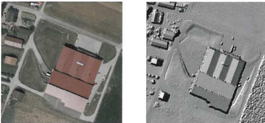
Abb. 7.9: Ergebnisse der DOM Ableitung mittels Laserscanning: links Luftbild, rechts Laserscanningergebnis (HAALA 2009)
