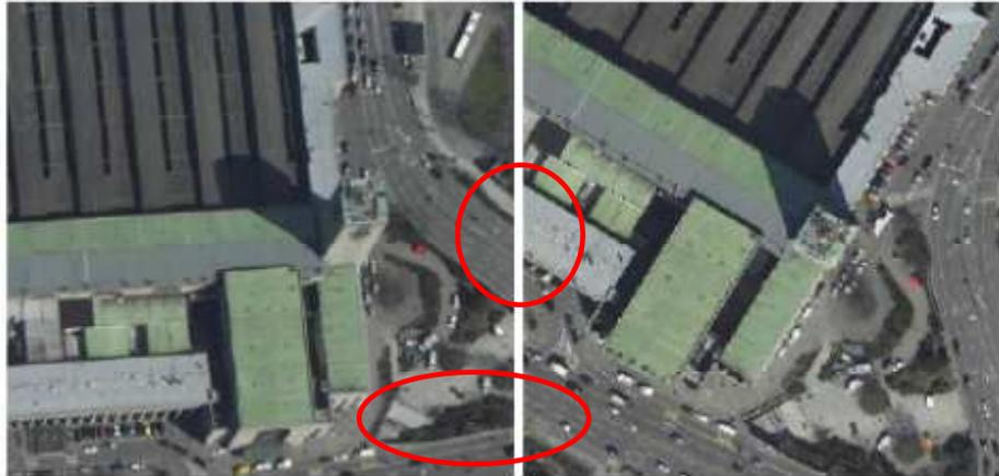
Abb. 7.21: Orthophoto (links), u. a. sind in den rot umrandeten Bereichen Hauswände sichtbar und leicht gedrehtes True Orthophoto (rechts; GÜNAY et al. 2007)
