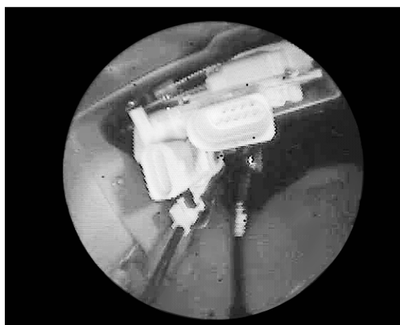
Abb. 5: Das Endoskop erzeugt ein kreisförmiges Bild auf dem Sensor.
