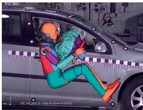
Abb. 8: Überlagerung von Simulationsdaten mit realen Bilddaten.
