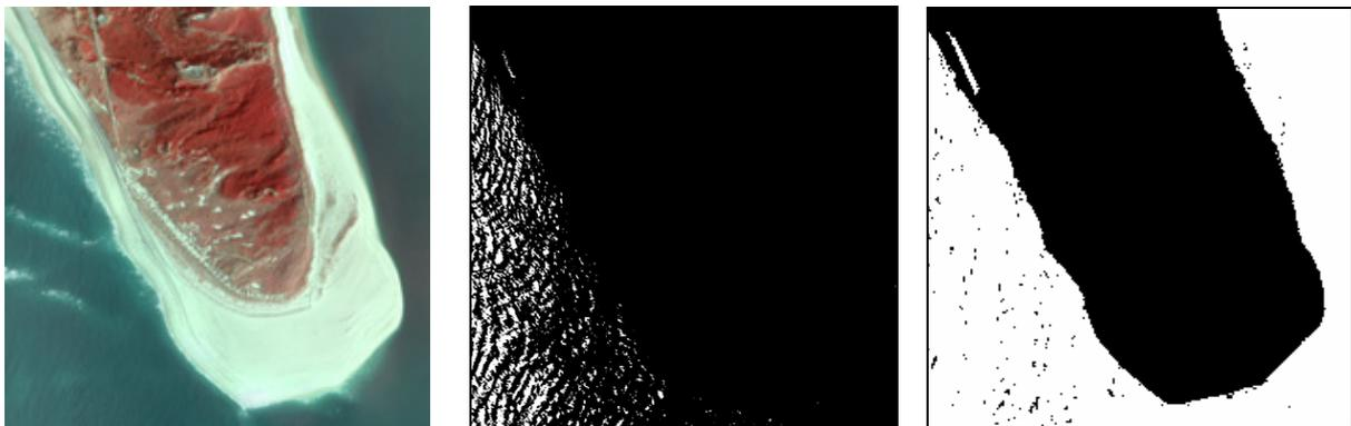
Abbildung 4: Ableitung von Wasserflächen aus dem Testdatensatz Sylt
