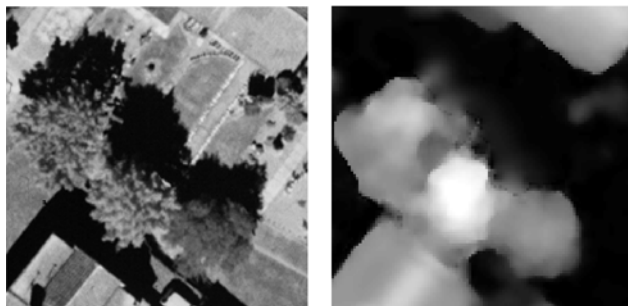
Abbildung 33: Abbildung von drei Bäumen in einem hochauflösten Farbinfrarotbild (dargestellt ist die Intensitätskomponente) mit einer Auflösung von 0.1 m und im entsprechenden Ausschnitt aus dem Oberflächenmodell. Auf diesen Ausschnitt wird im Text mit dem Namen DREI-BÄUME Bezug genommen.
