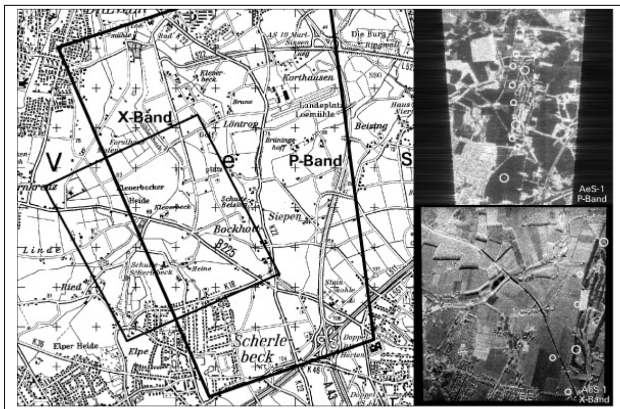
Abbildung 10: Lage zweier AeS-1 X-Band und P-Band Radar Ausschnitte in der TK50 (links), interferometrische Phasenbilder des P-Bandes (o.r.) und X-Bandes (u.r.), überlagert mit der Lage der Corner-Reflektoren (Kreise). Bereich der TK50: 5 km x 5 km.
