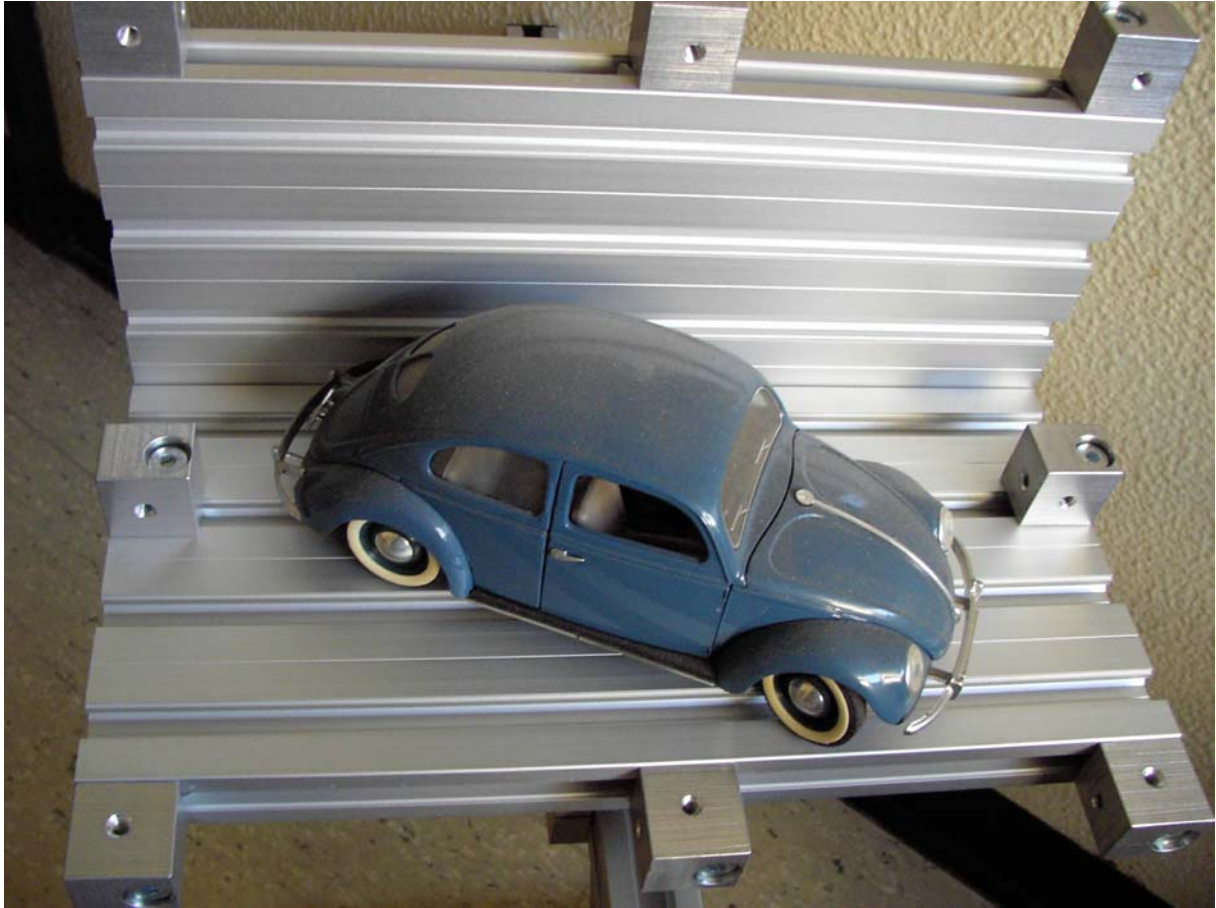
Abb. 3: Das Fahrzeugmodell. Die Ecken der beiden Aluminiumprofile wurden als Passpunkte verwendet.
