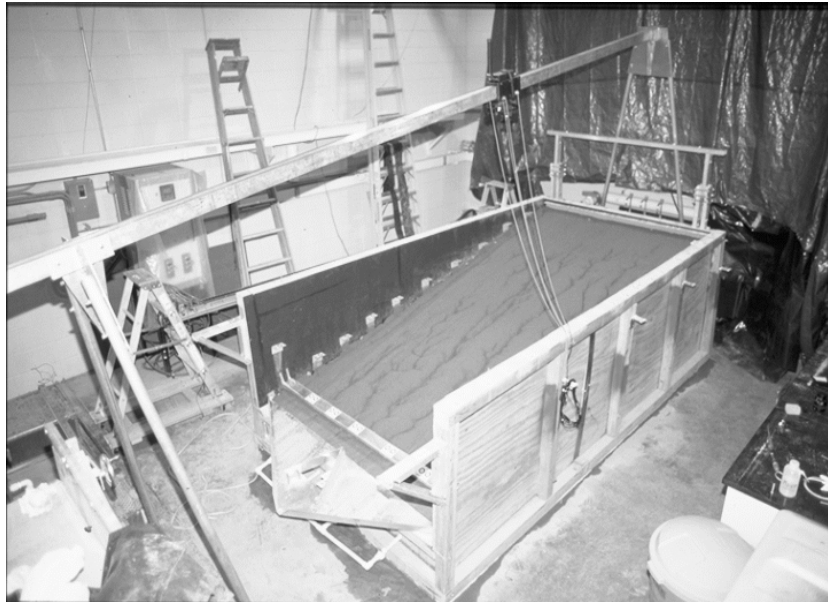
Abb. 1: Bodenerosionsmodell, Ausmasse der Box: 2.24 m breit und 4.18 m lang
