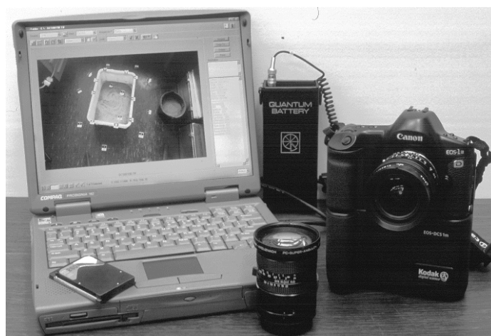
Abb. 2: Photogrammetrisches Aufnahme- und Auswertesystem
