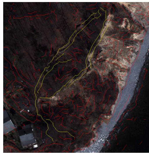
Abb. 5: extrahierte Kanten (rot, Geländestufe gelb) im Norden von Saßnitz.
