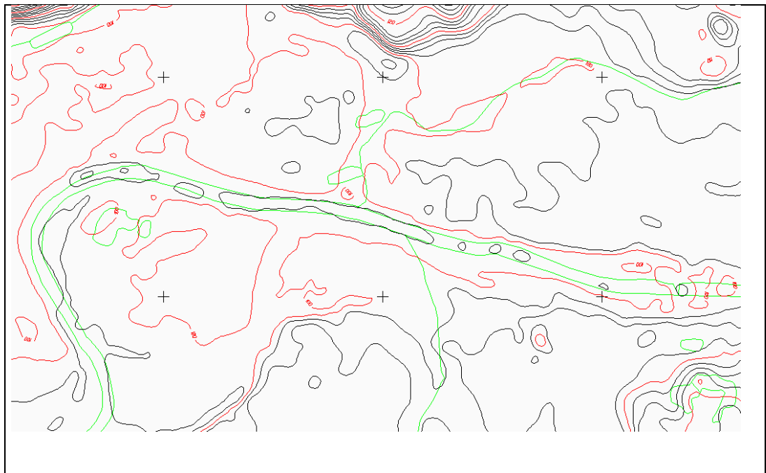
Abbildung 10: Situation vor der Anpassung: Höhenlinien verlaufen durch den Fluss; „Höhenlinieninseln“ im Fluss zeigen fälschlicherweise lokale Senken im Fluss an.
