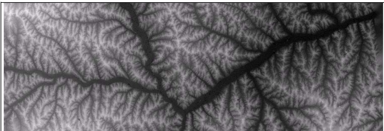
Abbildung 9: grauwertkodierte digitales Höhenmodell erstellt aus CORONA-4B-Aufnahmen - Lössplateau in China mit starker Erosion hell = hoch, dunkel = tief
